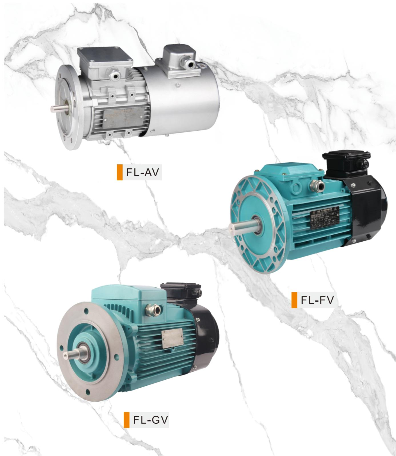
FL-AV/FV/GV系列铝壳变频调速三相异步电动机是一种由变频调速装置供电的专用电机，该系列电机在与变频调速装置组成的系统中，可实现无极调速，以达到节能和自动化控制的目的。FL-AV/FV/GV系列电机采用鼠笼型结构，运行可靠，维护方便，并配有独立的冷却风机，保证电机在不同转速下均有良好的冷却效果。
