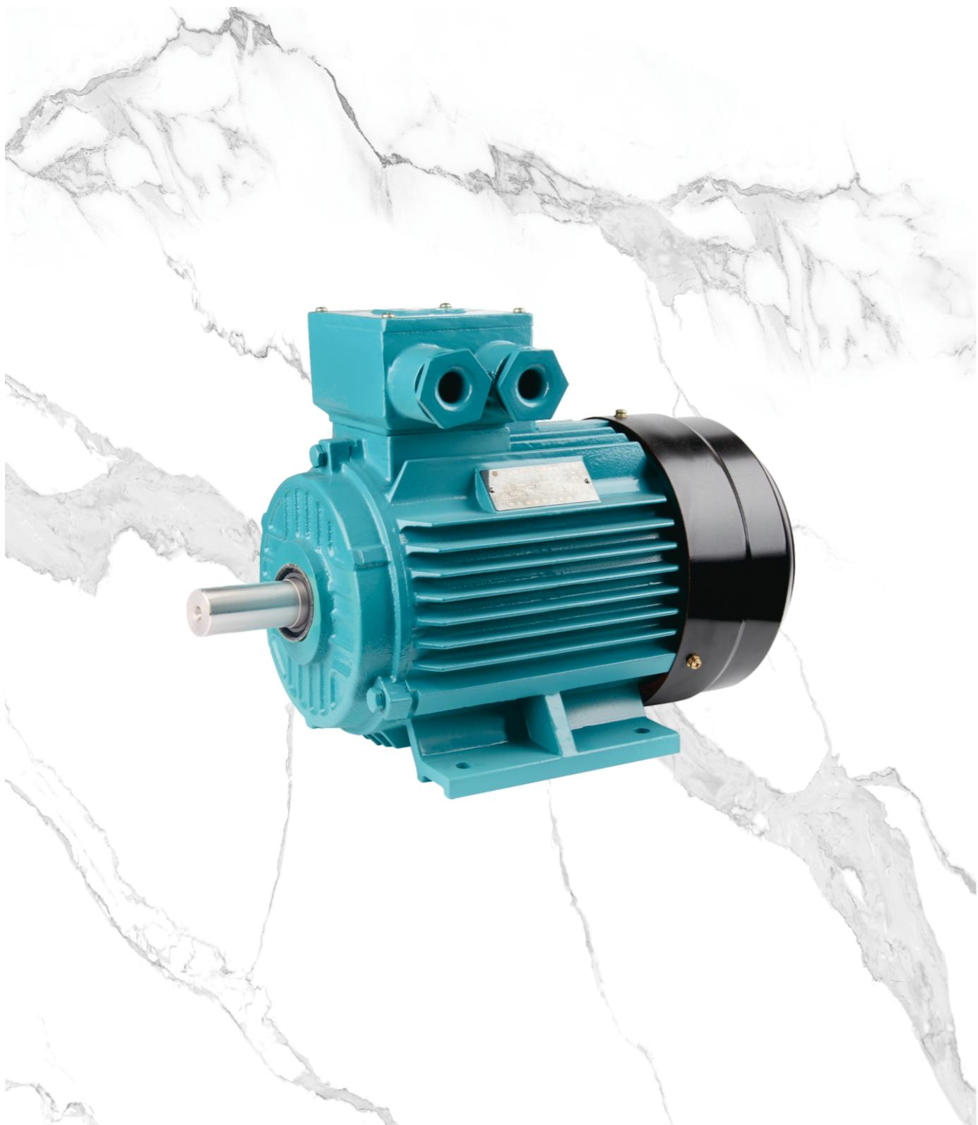
YFB2系列粉尘防爆型三相异步电动机是按照国家标准GB12476.1-2013《可燃性粉尘环境用电气设备 第1部分：通用要求》及GB12476.5-2013《可燃性粉尘环境用电气设备 第5部分：外壳保护型“tD”》的规定，制成粉尘防爆型。防爆标志为Ex tD A21 IP65 T130°C、Ex tD A22 IP65 T130°C。分别适用于工厂中具体有温度级别为T1、T2、T3、T4组，粉尘层或粉尘云与空气混合能达到爆炸浓度的21区或22区场所，户内及户外具有轻微腐蚀环境、湿热带地区户内及户外具有轻微腐蚀环境、以及户外具有中等微腐蚀环境中，作为机械驱动设备。
