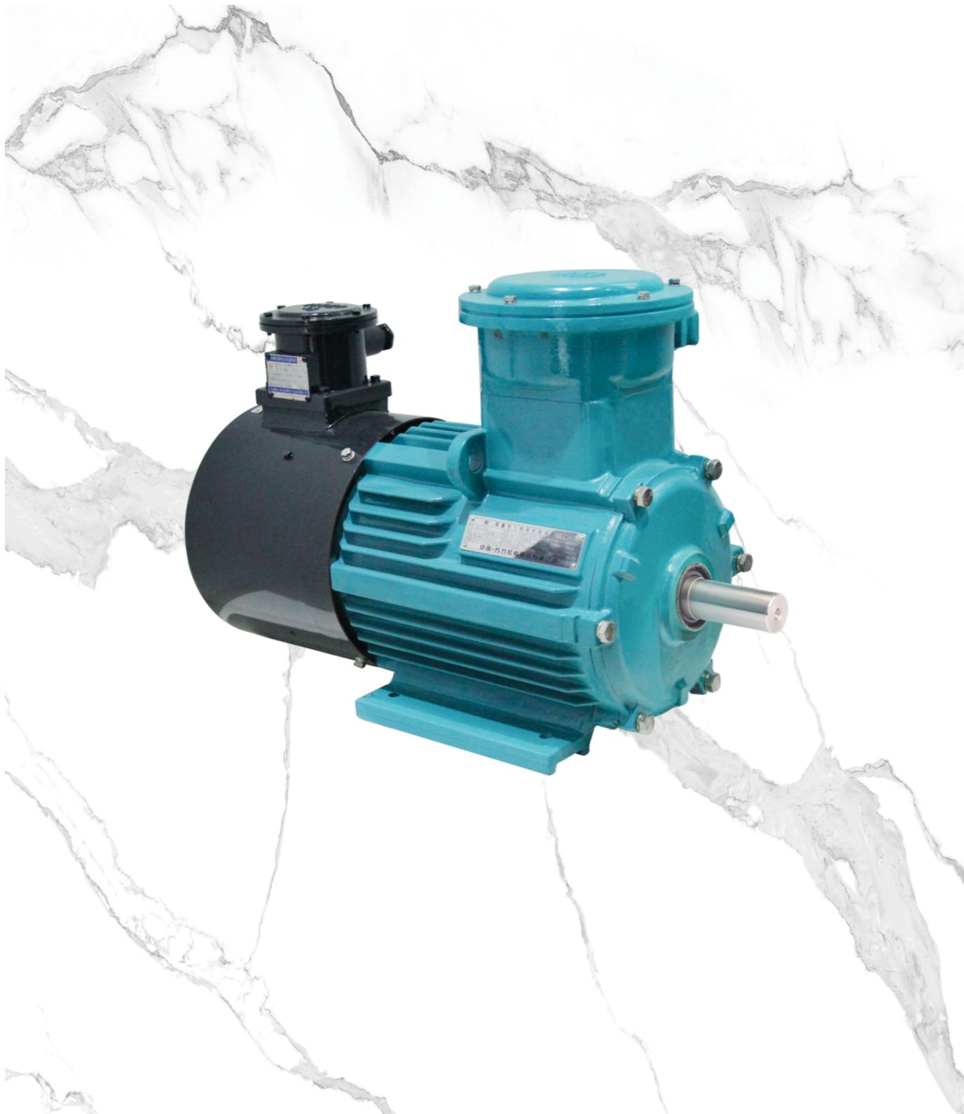
YBBP系列隔爆型变频调速三相异步电动机是YBX3系列隔爆型三相异步电动机的派生产品，该系列电机在与变频调速装置组成的系统中，可实现无极调速，以达到节能和自动化控制的目的。YBBP系列电机采用鼠笼型结构，运行可靠，维护方便，并配有独立的冷却风机，保证电机在不同转速下均有良好的冷却效果。
