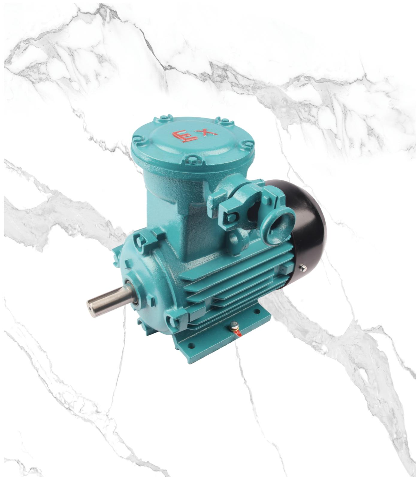
YBX3 系列隔爆型三相异步电动机是我公司在参考行业统一设计基础上研制开发的全封闭、自扇冷、鼠笼式、隔爆型三相异步电动机的基本系列。效率执行GB18613-2020《中小型三相异步电动机能效限定值及能效等级》中的能效限定值标准,效率达到国家III级能效,且具有性能优良,使用安全可靠,振动、噪声比同类产品小的特点,符合环保要求。
