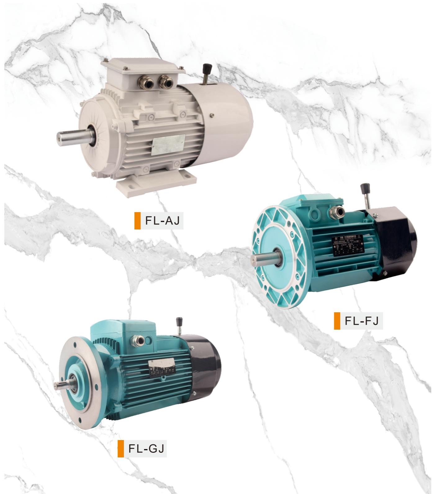
FL-AJ/FJ/GJ系列铝壳电磁制动三相异步电动机是一种全封闭自扇冷式鼠笼型三相异步电机。该系列电机按照IEC标准设计，具有启动转矩大、结构紧凑、制动迅速、运行可靠、高效节能，噪音低等优点。此外，电机设计有手动释放结构，既可以电磁制动，又可以手动操作，方便用户调试和使用。FL-AJ/FJ/GJ系列电机采用了铝合金压铸机座、端盖、接线盒、以及可拆卸式底脚，其安装尺寸与功率等级和YE3系列铝壳电机保持一致，适用于要求快速停止、准确定位、反复运转、频繁启动、防止滑行的各类机械设备中作为动力，如升降机、减速机、运输机械、包装机械、食品机械、印刷机械等。
