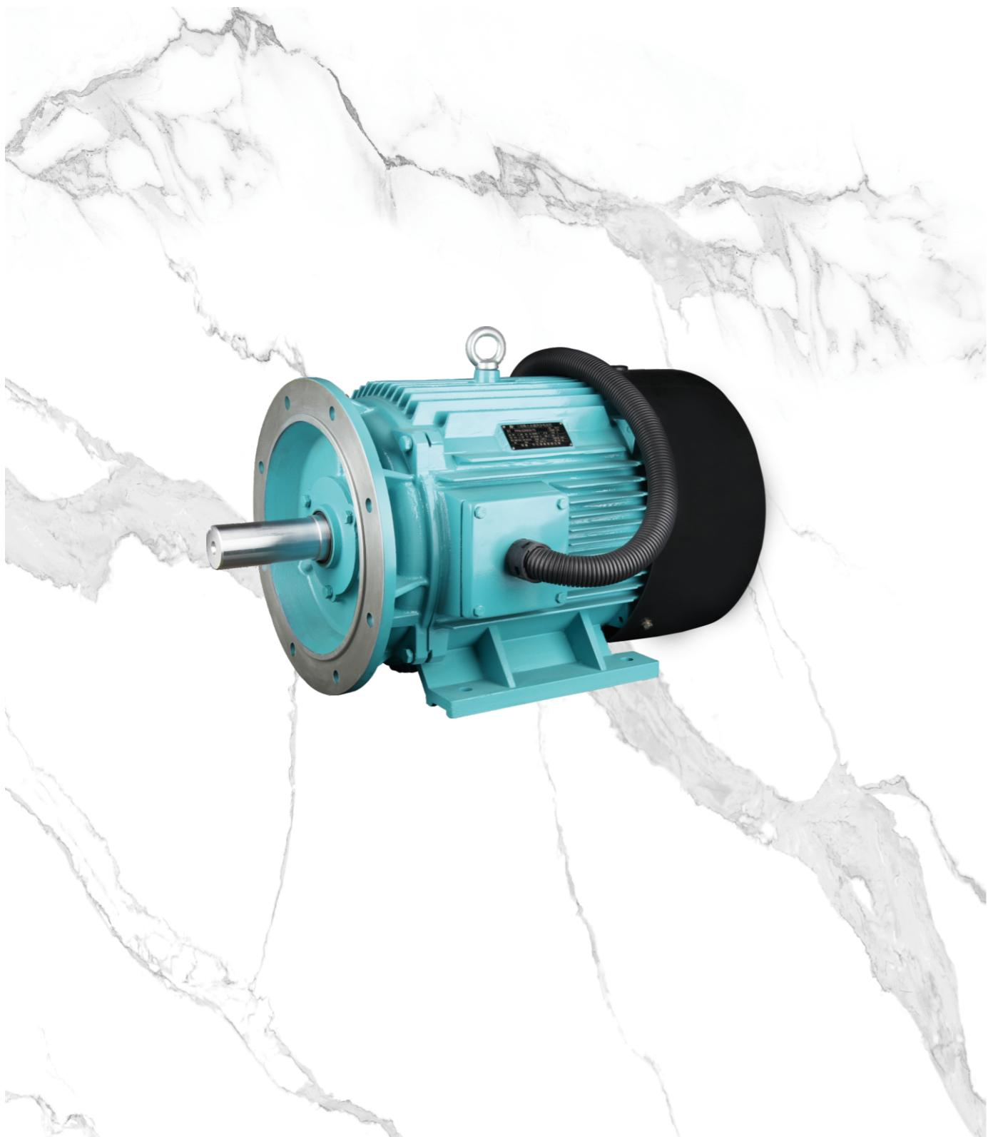
FL-K 系列空压机专用(IP54)三相异步电动机是专为螺杆压缩机配套而设计制造的，机座为高强度铸铁机座，接线盒位置分机座顶部或侧部两种。服务系数为SF1.15-SF1.35, 绝缘等级F级，在额定负载时温升按80K考核。在服务系数负载时，温升按99K考核，轴承温度应不超过95°C。FL-K 系列三相异步电动机采用特殊轴承配置，确保轴承能长期稳定工作，考虑电动机的电缆直接和压缩机的电控箱连接，可以为客户做加长引出线的配置，采用电缆护套保护管，两端配有电缆接头。
