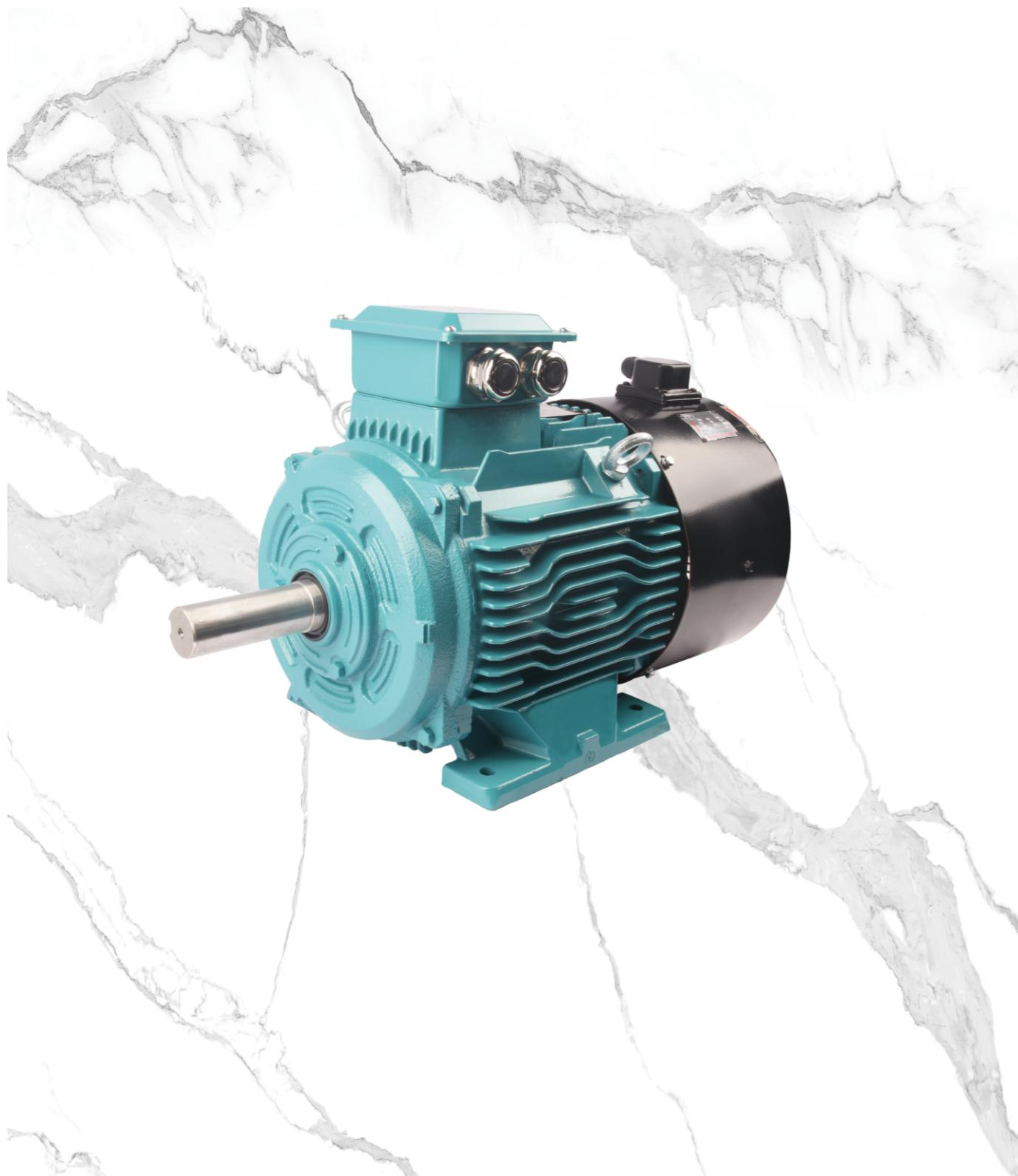
FL-V系列变频调速专用三相异步电动机是一种由变频调速装置供电的专用电机，该系列电机在与变频调速装置组成的系统中，可实现无极调速，以达到节能和自动化控制的目的。FL-V系列电机采用鼠笼型结构，运行可靠，维护方便，并配有独立的冷却风机，保证电机在不同转速下均有良好的冷却效果。
