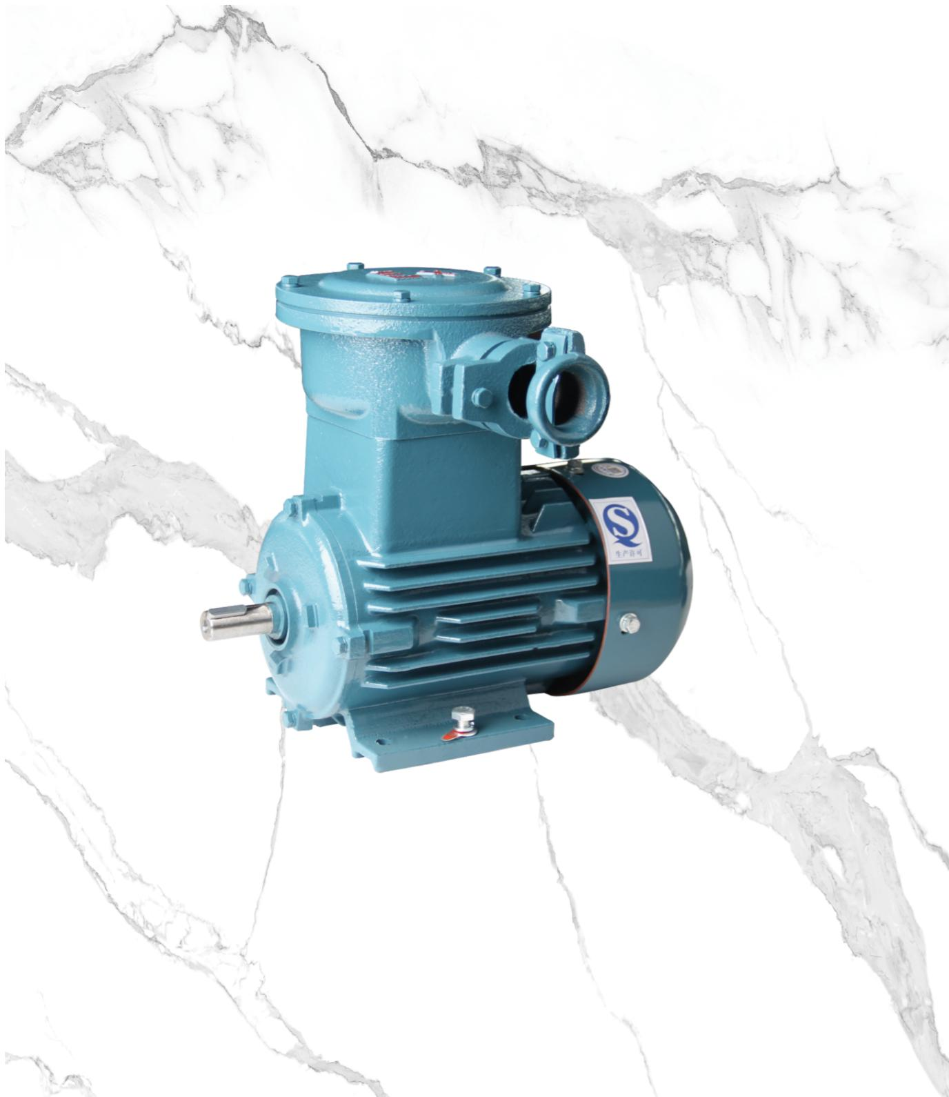
YBD3系列隔爆型变级多速三相异步电动机是YBX3系列隔爆型三相异步电动机的派生产品。本系列电机采用绕组变极方法实现转速变换，用户使用时只需选择相应的接法，即可使电机以对应的转速转动。
